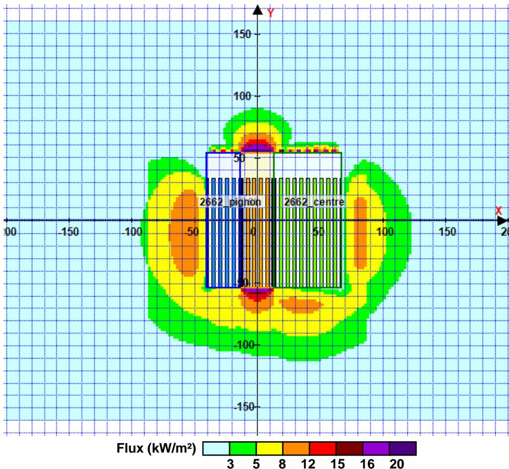
**Avertissement:** Dans le cas d'un scénario de propagation, l'interface de calcul Flumilog ne vérifie pas la cohérence entre les saisies des caractéristiques des parois de chaque cellule et la saisie de tenue au feu des parois séparatives indiquée en page 2 de la note de calcul.
